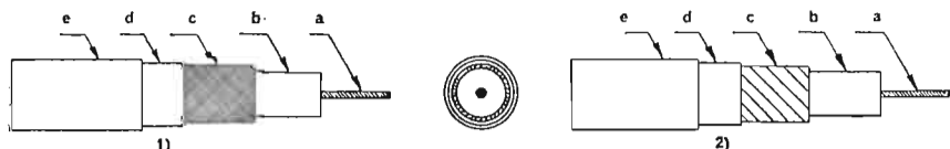
Fig. 2/0371 - a = conduttore in filo di rame rosso sezione piena; b = isolante a minima perdita; c = schermo o treccia in rame rosso, o treccia a nastri; d = sottile film antimigrante; e = guaina protettiva in materiale sintetico.
