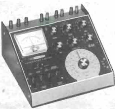
Uno strumento adatto a misure in continua dei parametri di tutti i transistori pnp e npn fino a 15 A, è stato presentato sotto forma di scatola di montaggio dalla HEATHKIT. Si tratta del modello IM-30.
